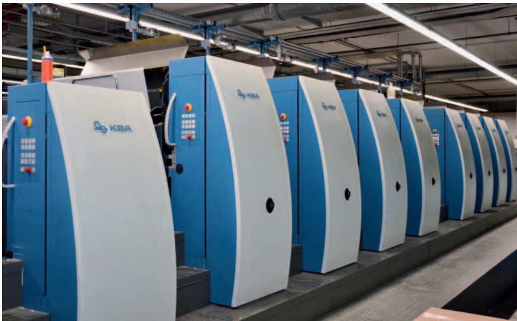
Die KBA Rapida 106 LED-UV ist eine Achtefarben-Maschine (mit Wendung 4/4-farbig) samt Lackturm und verlängerter Trockenstrecke für die Verarbeitung von konventionellen und UV-Lacken.
